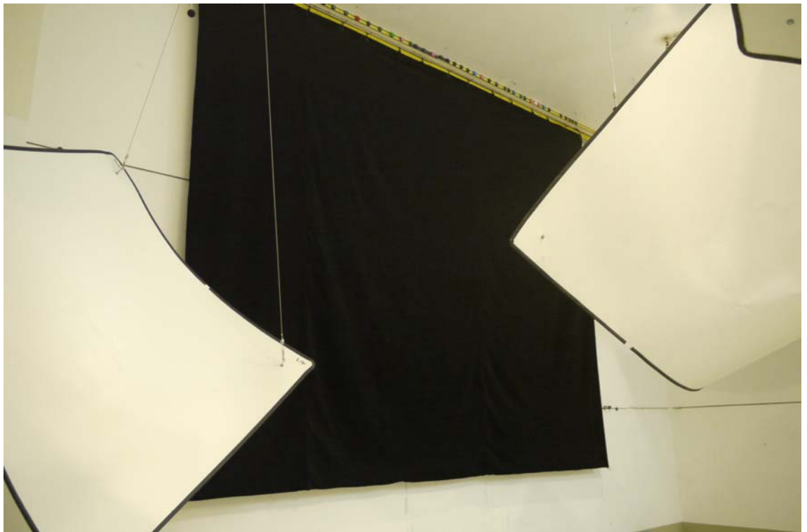
Foto B.1 Prüfaufbau im Hallraum – Samtgewebe VERDI glatt hängend (Aufbau 1)
